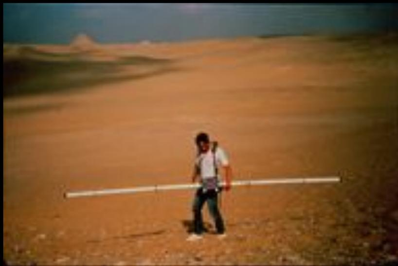
Les prospections géophysiques d'EDF : utilisation de l'E.M. 31, qui comprend sur son support portable horizontal un émetteur et un récepteur permettant une analyse en sous-sol jusqu'à 8 mètres de profondeur (photo EDF).
